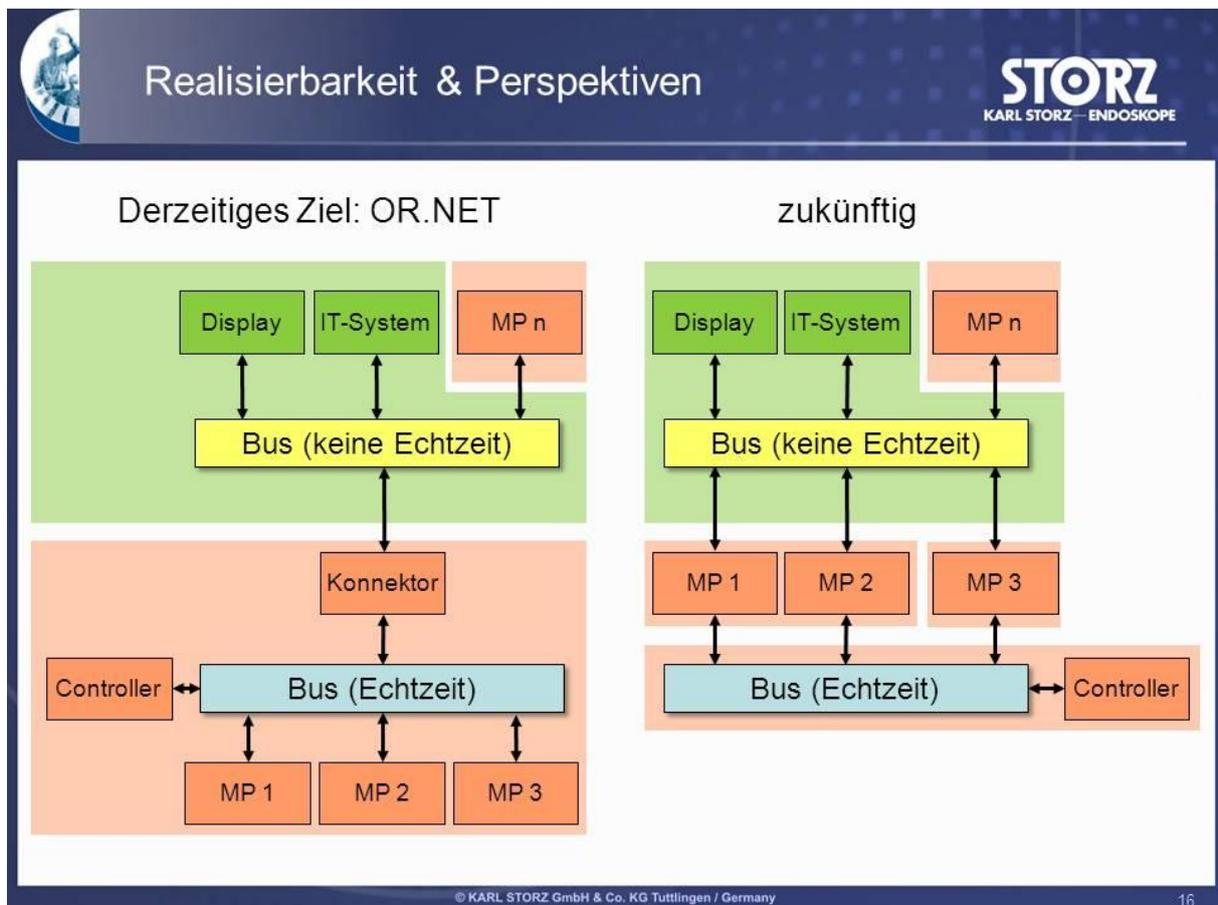
Irion zeigte sich überzeugt, dass es zukünftig nicht nur eine offene Kommunikationsstruktur im OP geben wird. Unkritische Datenkommunikation wird über offene Plattformen bzw. Bussysteme laufen. Die Geräte müssen dazu dem Bussystem a priori bekannt sein. Sicherheits-
